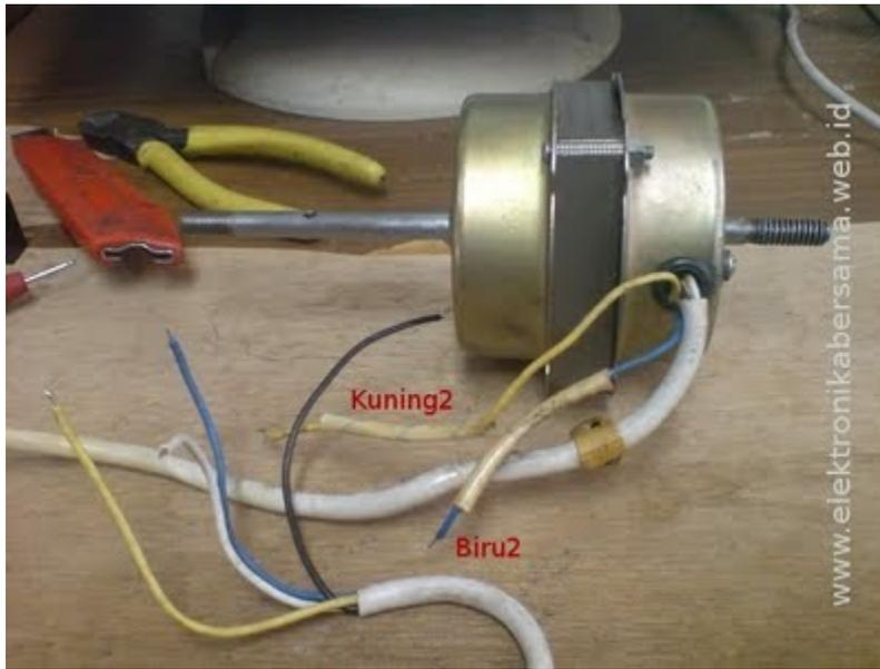
Ada dua buah bagian kabel, satu bagian terdiri dari 2 kabel (kuning2 dan biru2) dan bagian lain 4 kabel (kuning, putih, biru, dan hitam). Bagian yang terdiri dari 2 kabel merupakan bagian yang tersambung ke kapasitor, sedangkan bagian yang terdiri dari 4 kabel, tersambung ke saklar pengatur putaran (1: lambat, 2: sedang, dan 3: cepat).
