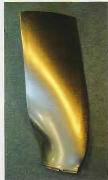
A hollow wide-chord fan blade
